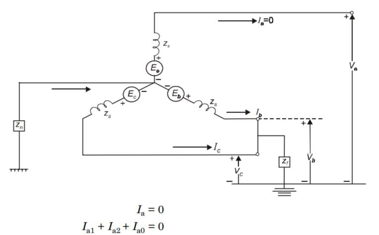
$V_{\rm b} = V_{\rm c} = (I_{\rm b} + I_{\rm c}) Z_{\rm f} = 3Z_{\rm f} I_{\rm a0}$
